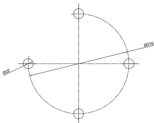
3- En lugar de usar columna de hierro se puede utilizar columna de hormigón. En este caso se tendrían que poner unos espárragos M20 que sobresalgan unos 60 mm. Las medidas están en el dibujo adjunto.
