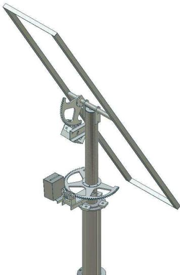
8-Se colocan los sistemas con el tornillo sin fin que engranan a las ruedas dentadas.
