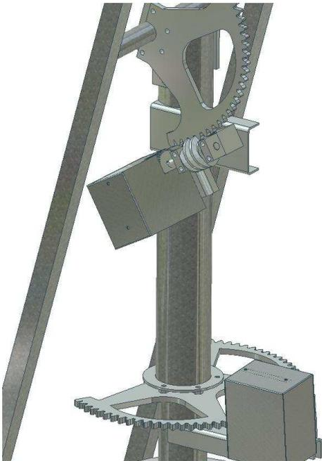
11. Montamos las protecciones de los motores.
