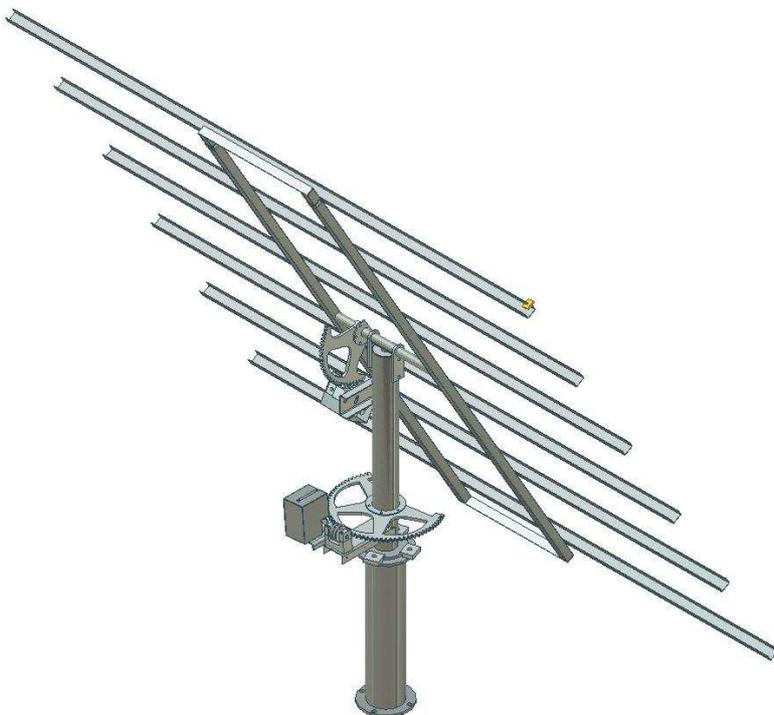
9-Se instala la caja electrónica, (a la columna o unida a la caja de protección del motor horario), se enchufan los motores y los microinterruptores y se conecta el sistema a través de la apertura inferior con 12 voltios corriente continua. En la regleta interior ya está
