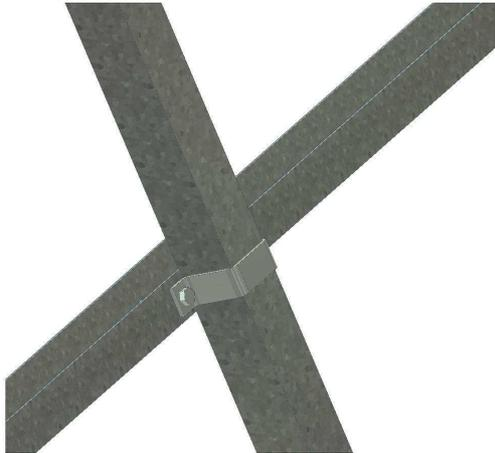
11- Montar las bridas de soporte de las barras horizontales como se muestra en la imagen y fijaremos las barras a la distancia que consideremos más oportuna para los paneles que queramos montar.
