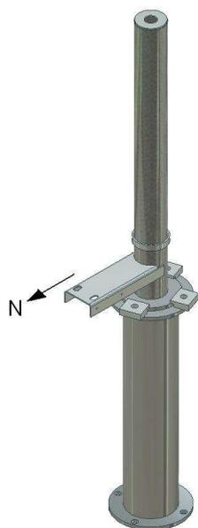
2- Se pone la parte fija en dirección al norte, tal y como muestra la imagen (tornillos M20 i tuercas).
