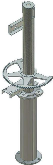
5- Se coloca el tubo movil y se roscan los 4 tornillos de sujeción del volante.
