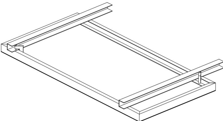
12- Montamos los paneles con las bridas suministradas tal como se muestra en la figura.
