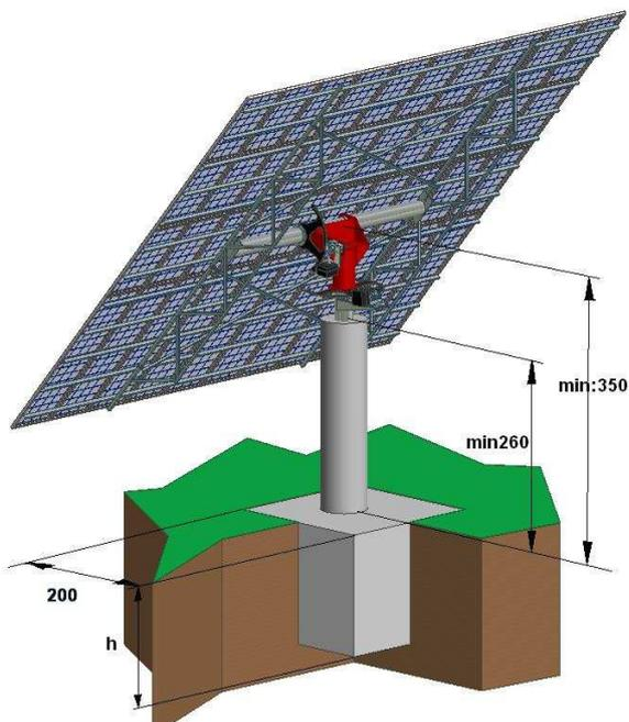
Los valores son válidos para las alturas que se muestran en los dibujos, para una superficie de paneles de 45 m<sup>2</sup>, para una velocidad del viento de 140 km/h, y un coeficiente de seguridad de 1,6.
