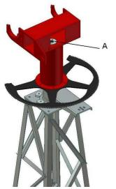
6-Se introduce la parte móvil, se fija el volante con cinco tornillos M20 y sus tuercas. Se pone la arandela (A), (tornillos M10) para que no pueda salir el conjunto.
