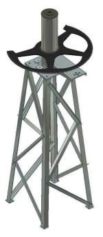
5- Se introduce el volante de movimiento horario.
