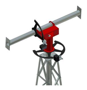
9- Se colocan los motores y sus cajas protectoras.
