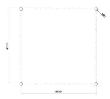
1- Se hace el cimientos de hormigón, donde se ponen 4 varillas roscadas de un metro de largo y de M24. Tienen que sobresalir unos 70mm del hormigón. La distancia entre ellas es la que se muestra en la imagen.
