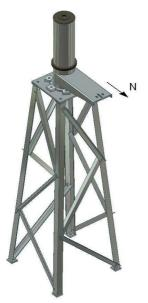
3- Se coloca la parte fija en dirección al norte, tal como muestra la imagen (tornillos M20 y tuercas). Los 6 tornillos se tienen entornillar con 590 Nm. Localizando una referencia lejana con un mapa topográfico o con una fotografía por satélite bien orientada, se puede determinar el norte con mucha más precisión que con una brújula.
