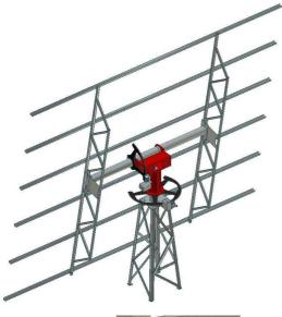
11- Se colocan las barras en forma de "U", como se especifica más adelante. Si se pone el seguidor en posición horizontal alimentando el motor con 12 V, se puede facilitar la tarea.
