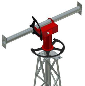
8- Se coloca la porción de corona dentada con cuatro tornillos M20 y sus tuercas.
