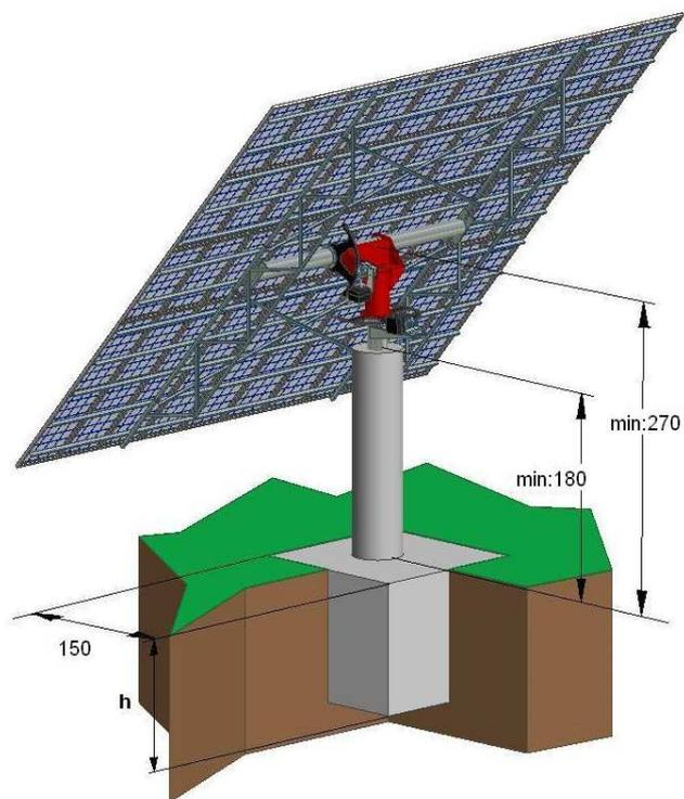
Los valores son válidos para las alturas que se mencionan, para una superficie de paneles de 28 m<sup>2</sup>, para una velocidad del viento de 140 km/h, y un coeficiente de seguridad de 1,6.
